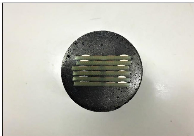
Obrázek 24. Vzorky zalité v pryskyřici vhodné pro analýzu intermetalických vrstev
